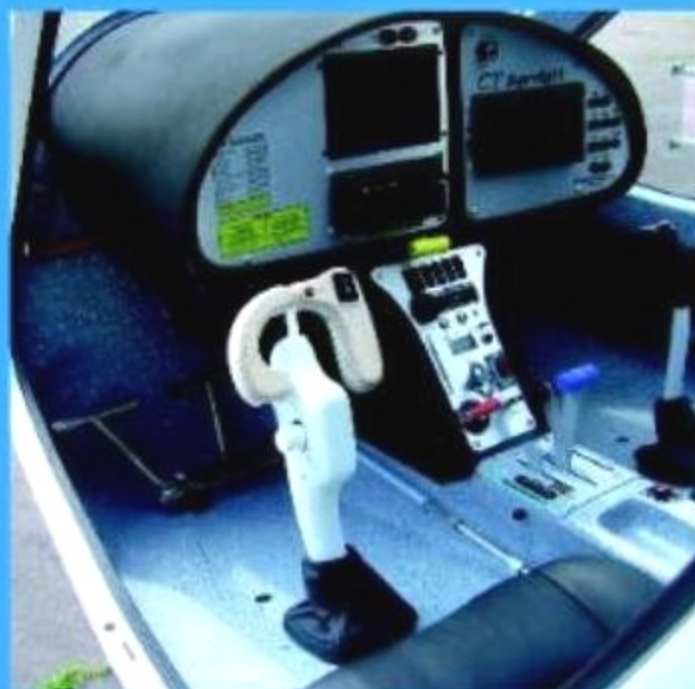
Flight Design heeft zijn populaire CT aangepast voor mindervalide piloten.
