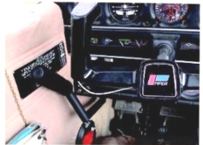
Extra handrem aan de linkerkant van de cockpit.
