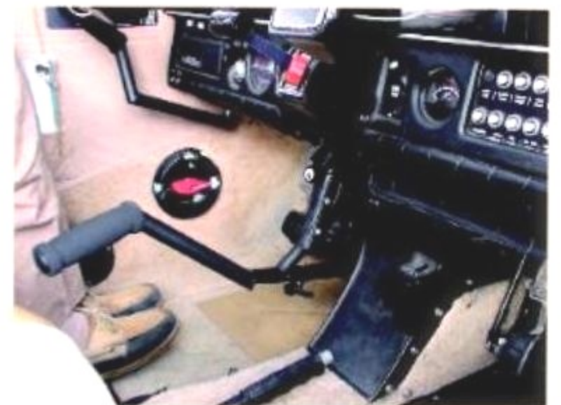
Extra handmatig te bedienen rudder control aan de rechter kant van de bestuurdersstoel.
