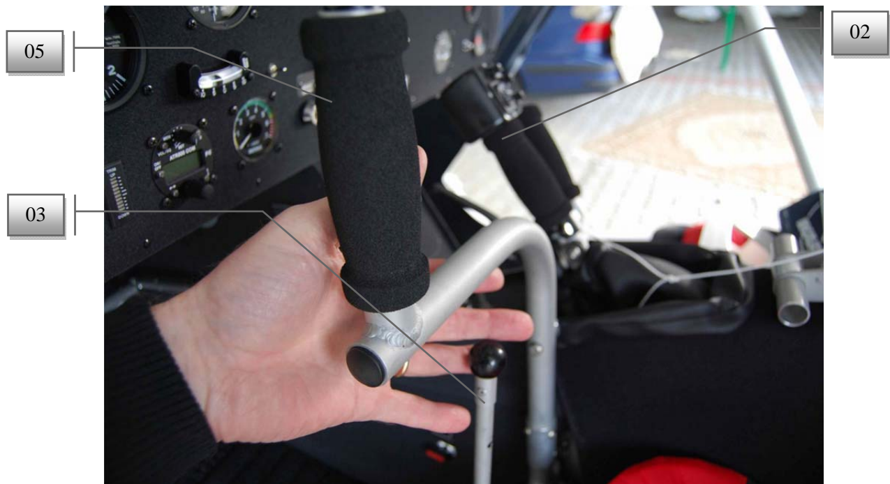
Foto 3: De demonteerbare hendel, waarmee de andersvalide piloot de pedalen kan bedienen
