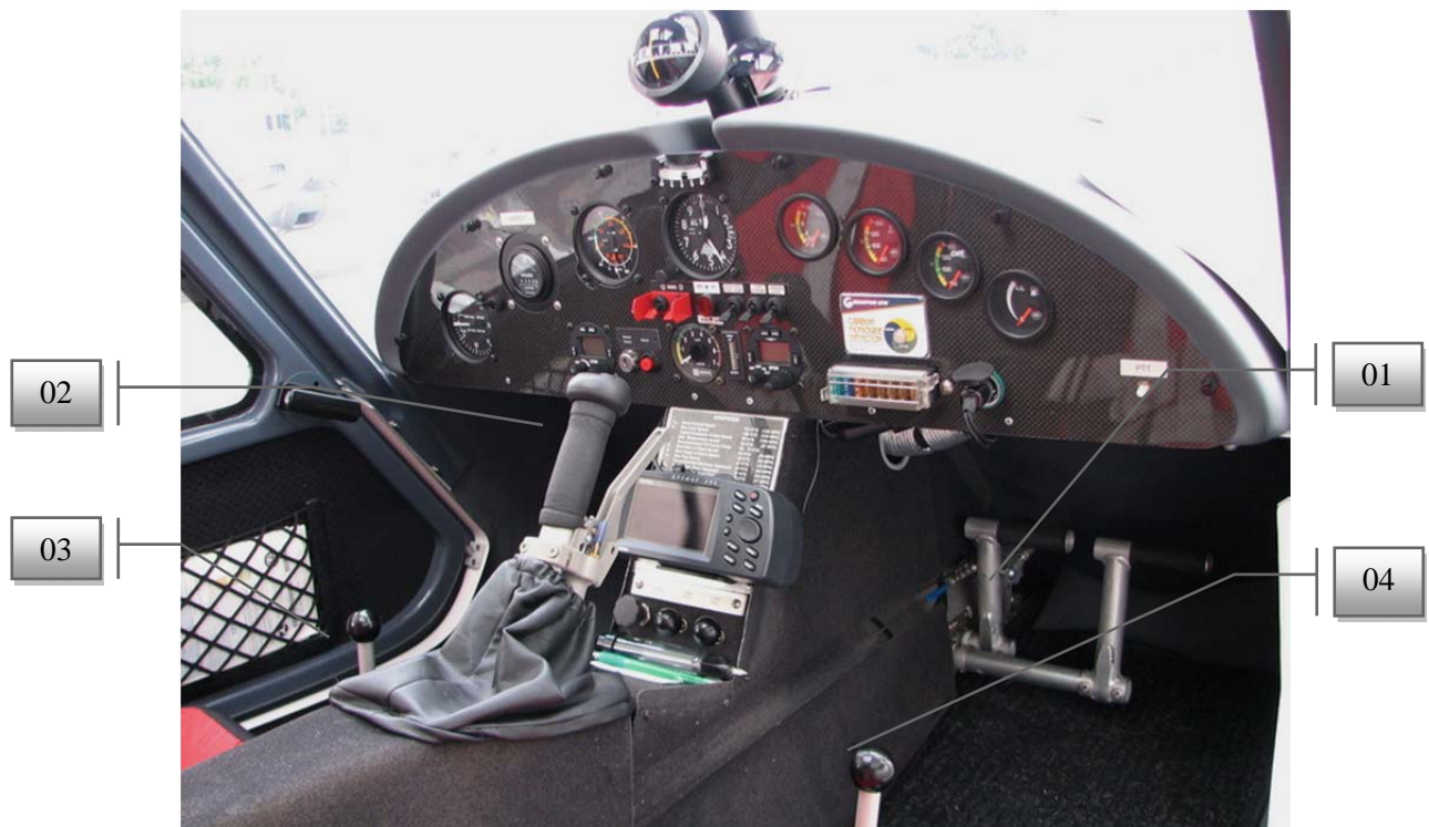
Foto 2: Standaard cockpit v/d Ikarus C42 met de typisch centrale flight stick en gashendels
