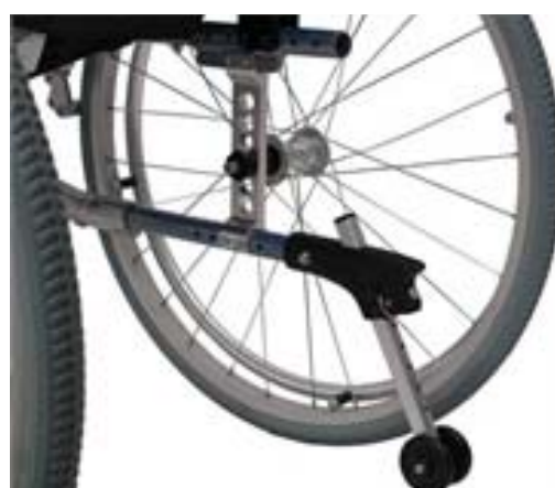
Fig. 12 – Links: rolstoel met extra Free Wheel vooraan. Rechts: Een anti-tip wiel gemonteerd achteraan
