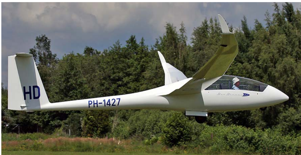
Fig. 04 - Een duo Discus XLT. Tweezitter voor gevorderde opleiding in overlandsvluchten en ideaal voor wedstrijdvluchten.
