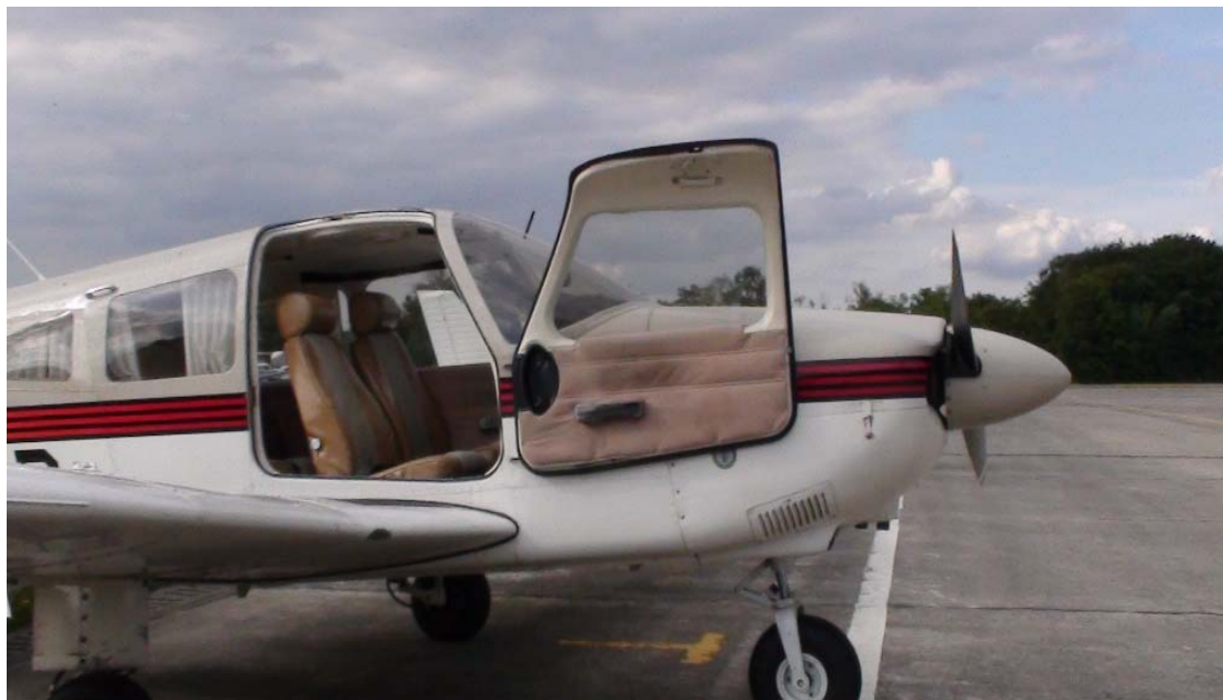
Fig. 07 – Volledig opendraaiende toegangsdeur biedt de gehandicapten een betere toegang
