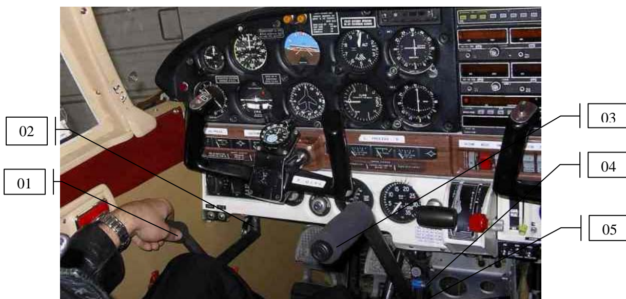
Fig. 06 – Cockpit van een Piper P28A met gemonteerde LPS hand controls.
