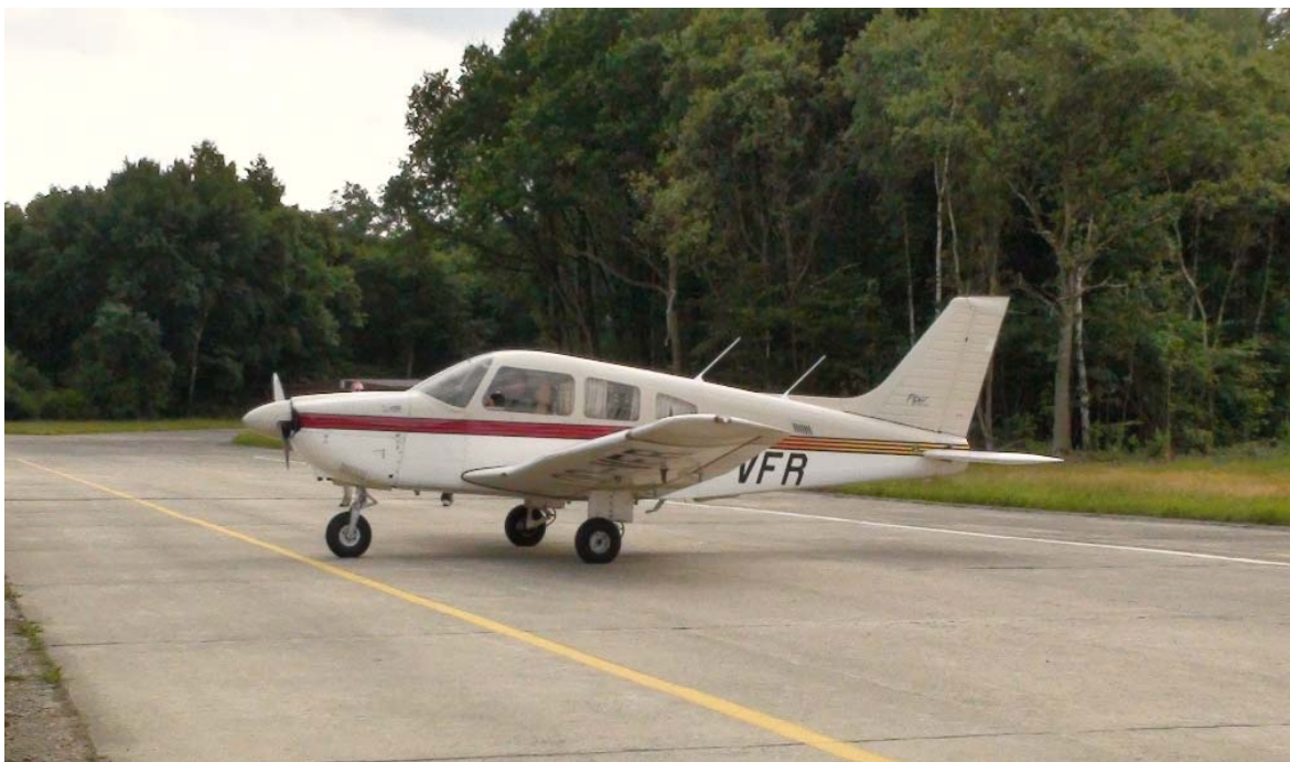
Piper P28A met immatriculatie OO-VFR Het eerste sportvliegtuig in België aangepast met volledige handbesturing, gebaseerd in Ursel
