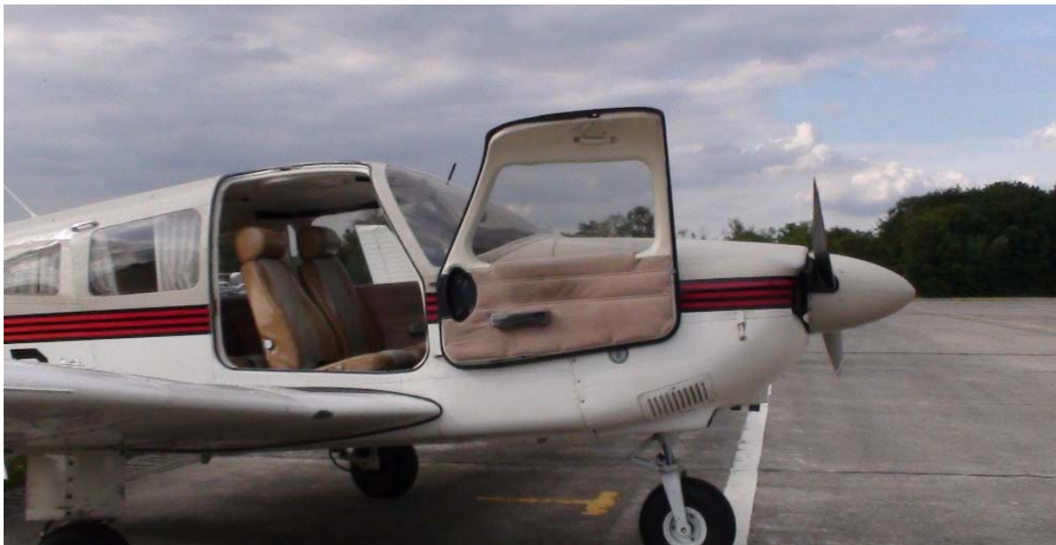
Fig. 06 – Volledig opendraaiende toegangsdeur biedt de mindervaliden een betere toegang tot de cockpit
