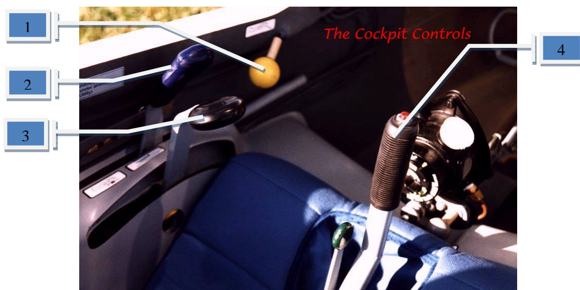
Le cockpit avant d'un ASK21 ADAPTE avec un malonnier.
